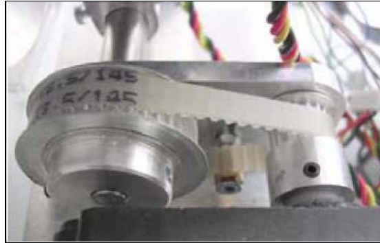
Figura 2-2 - Polias de transmissão existentes ao longo da estrutura
